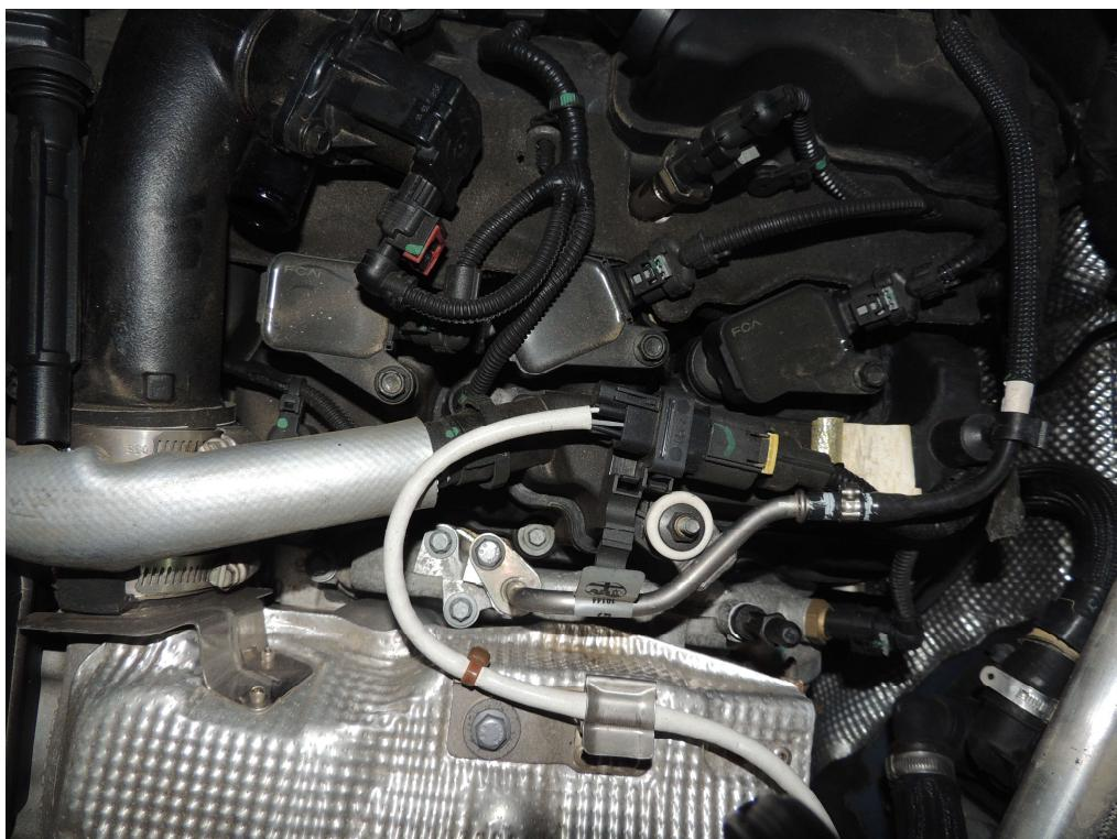
Rebranchez le tuyau de bypass entre l'électrovalve de contrôle de la surpression et le turbocompresseur .
