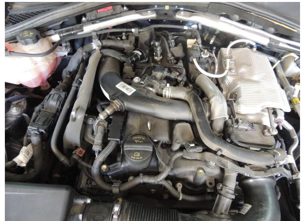
Desserrez les colliers et débranchez le tuyau de bypass entre l'électrovalve de contrôle de la surpression et le turbocompresseur .
