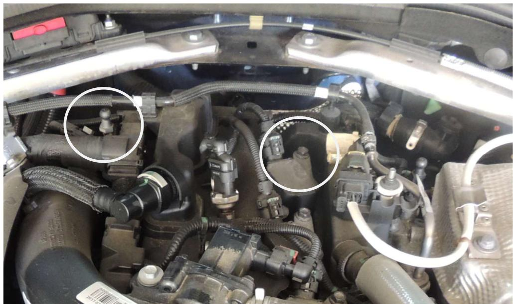
Vissez les 2 vis de fixation du couvercle insonorisant à l'avant, et remettre les opturateurs en place
